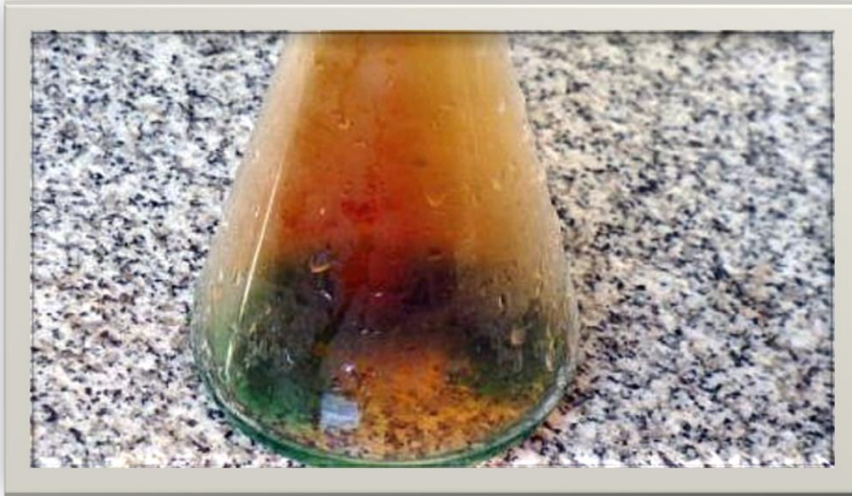
Reacción del ácido nítrico con el cobre
