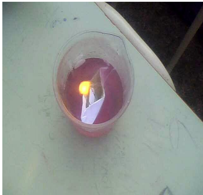
Reacción del sodio metálico con el agua (en presencia de un indicador)
